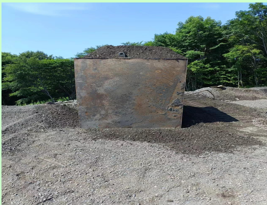
图 2-3：移动式钢结构避炮棚
